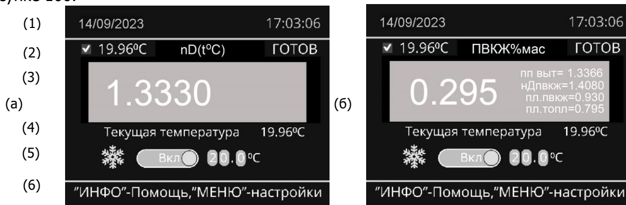
Рисунок 10 (10а–окно измерений для шкалы n_D(t^{\circ}\text{C}) ; 10б–для шкалы массовой доли ПВКЖ)
